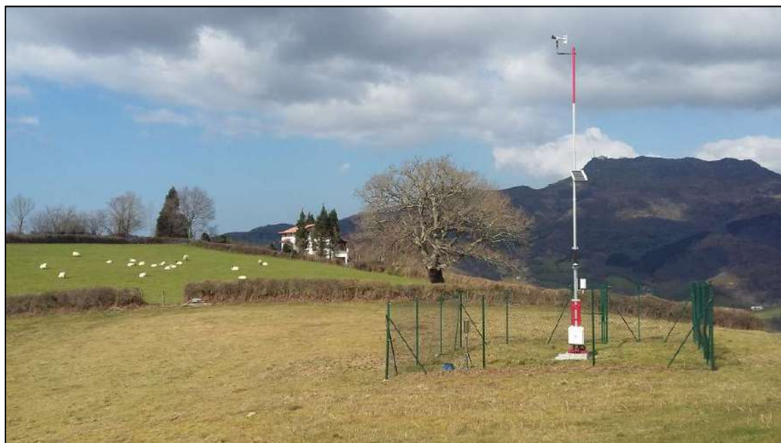
Figura 13 Imagen de la estación automática con comunicación de datos en tiempo real de Bera-Larrategaia perteneciente a la red de observación del Gobierno de Navarra (Meteonavarra)
