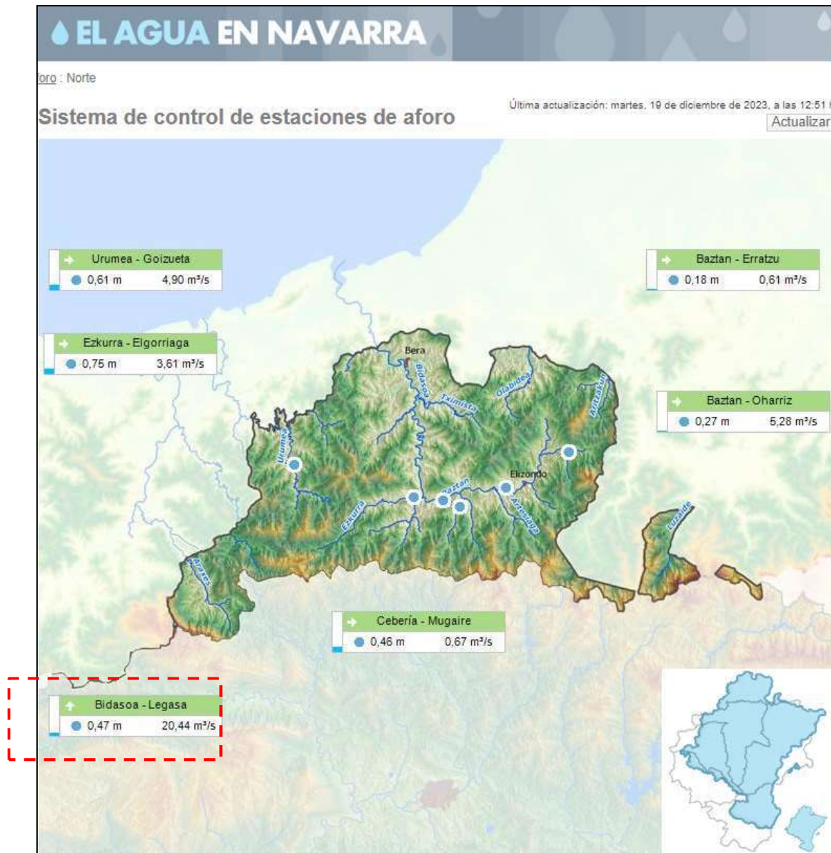
Figura 7. Página web del Agua en Navarra donde se pueden consultar los datos en tiempo real comunicados desde las diferentes estaciones de aforo disponibles en los cauces de la cuenca de los ríos Baztan-Bidasoa. Datos de las estaciones gestionadas por el GN, con Legasa (GN) ya en funcionamiento.
