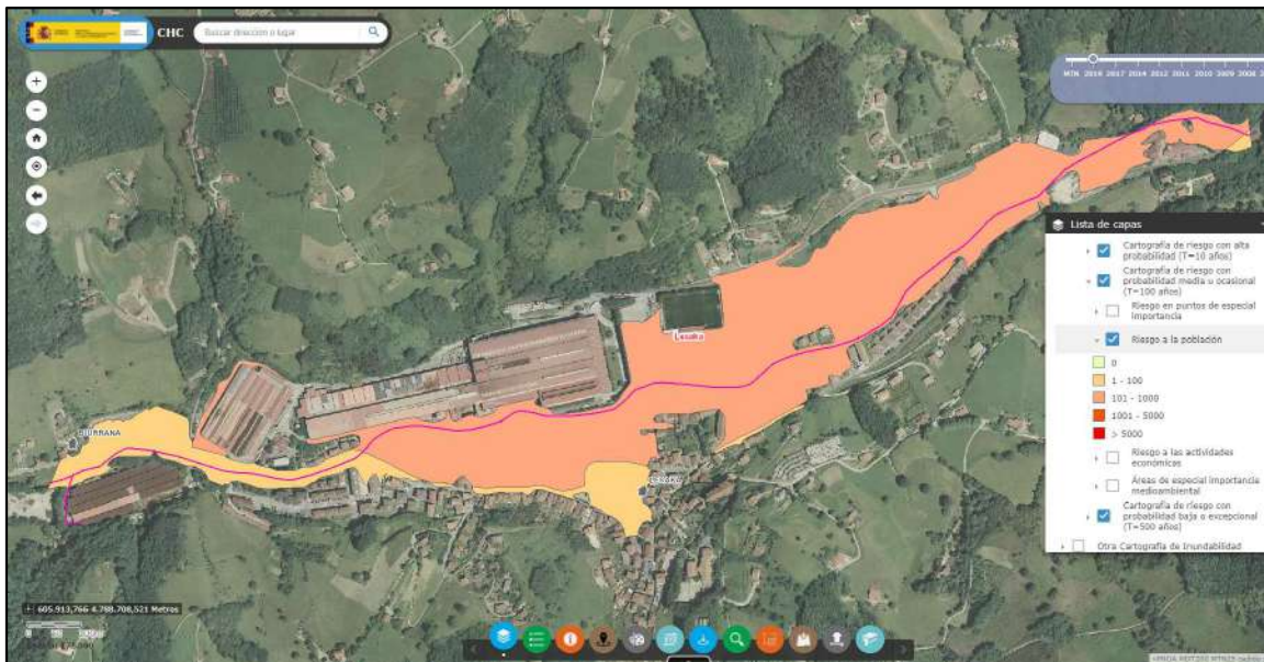
Figura 33 Mapa de la estimación del número de personas afectadas por la inundación asociada a un periodo de retorno de 100 años en zona del término municipal de Lesaka [datos del segundo ciclo].
