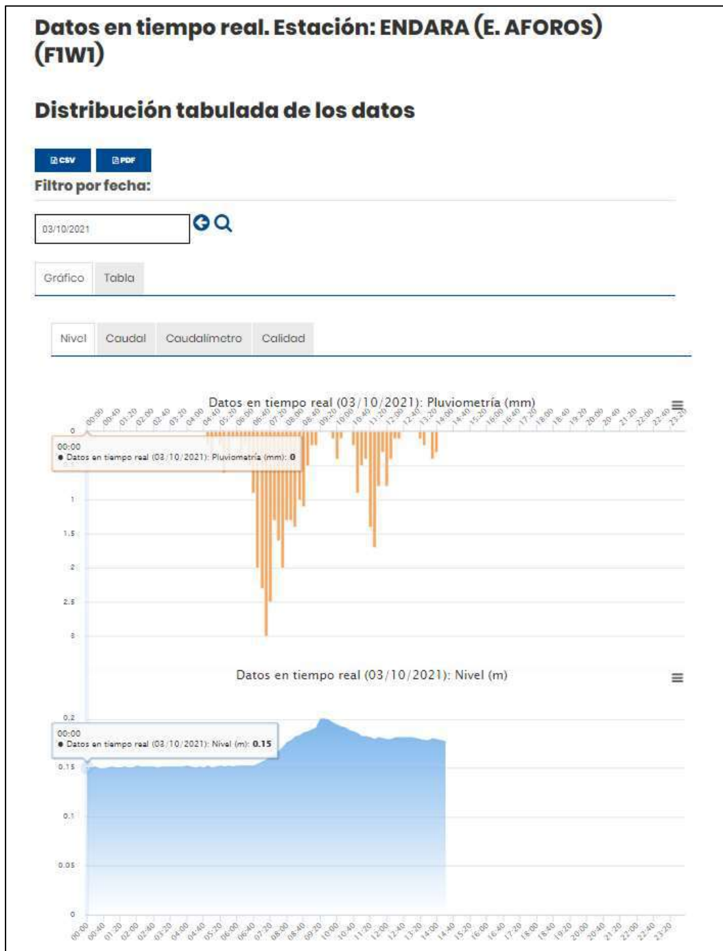
Figura 11 Datos de pluviometría y caudal observados en la estación de la Diputación Foral de Gipuzkoa ubicada en Endara.
