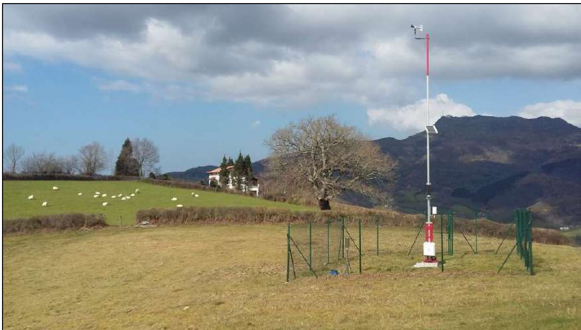
Figura 13 Imagen de la estación automática con comunicación de datos en tiempo real de Bera-Larrategaña perteneciente a la red de observación del Gobierno de Navarra [Meteonavarra]
